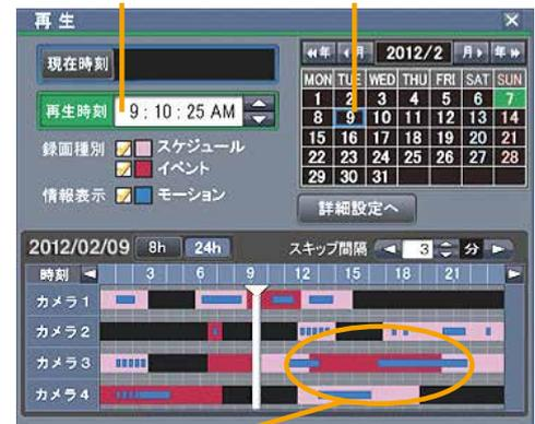
再生スライダーをドラッグして、見たい部分を即座に頭出し。色分け表示により、動き検知やアラーム発報がいつ動作したか、ひと目で分かるので、わずらわしい検索操作は不要。青…モーション(動き検知) 赤…イベント(アラーム発報)
